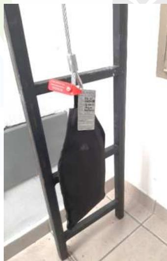
**El kit cuenta con gancho de seguridad, absorbedor de choque en acero inoxidable, no requiere cambio en caso de ser impactado, tramo de cable y contra peso.**
